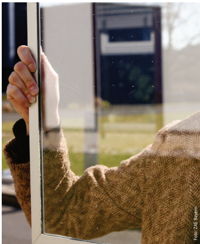
Blick durch ein Vakuumisolierverglas. Die Stützen im Scheibenzwischenraum beeinträchtigen die Durchsicht nicht.
